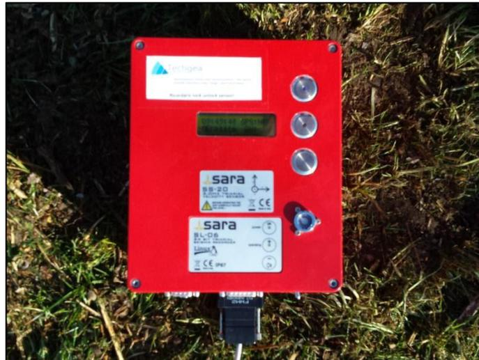
Figura 3 – Strumentazione utilizzata – Registratore sismico SL06
