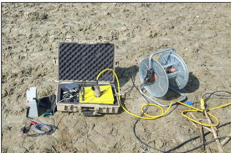
Figura 2 – Strumentazione utilizzata – Sismografo Daq Link IV e laptop
